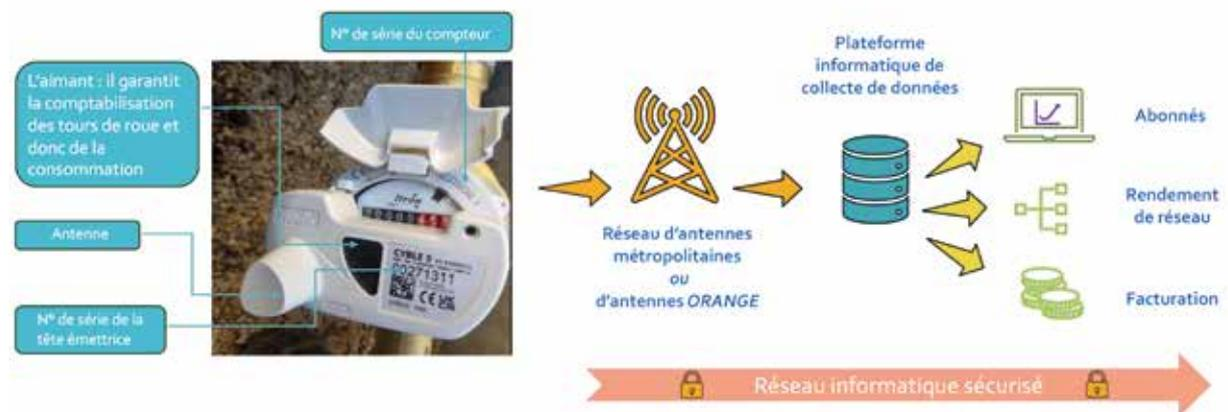
La Métropole travaille en parallèle à la densification du réseau d'antennes afin de réduire les « zones blanches ». L'emplacement du compteur est également déterminant pour la bonne réception du signal (fosse, regard au sol, profondeur...)
