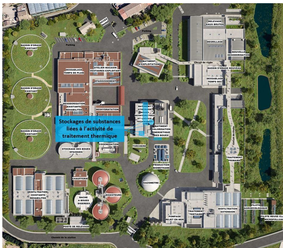
Figure n°59. Localisation des stockages de substances dangereuses
