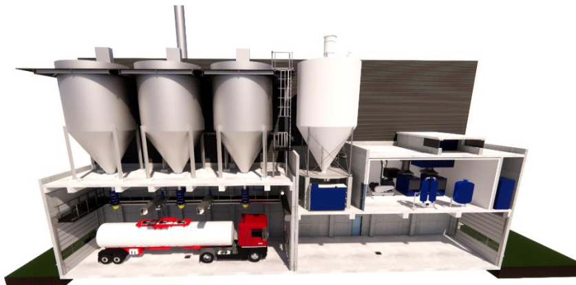
Figure n°77. Silos de cendres et résidus de l'unité de valorisation énergétique des boues
